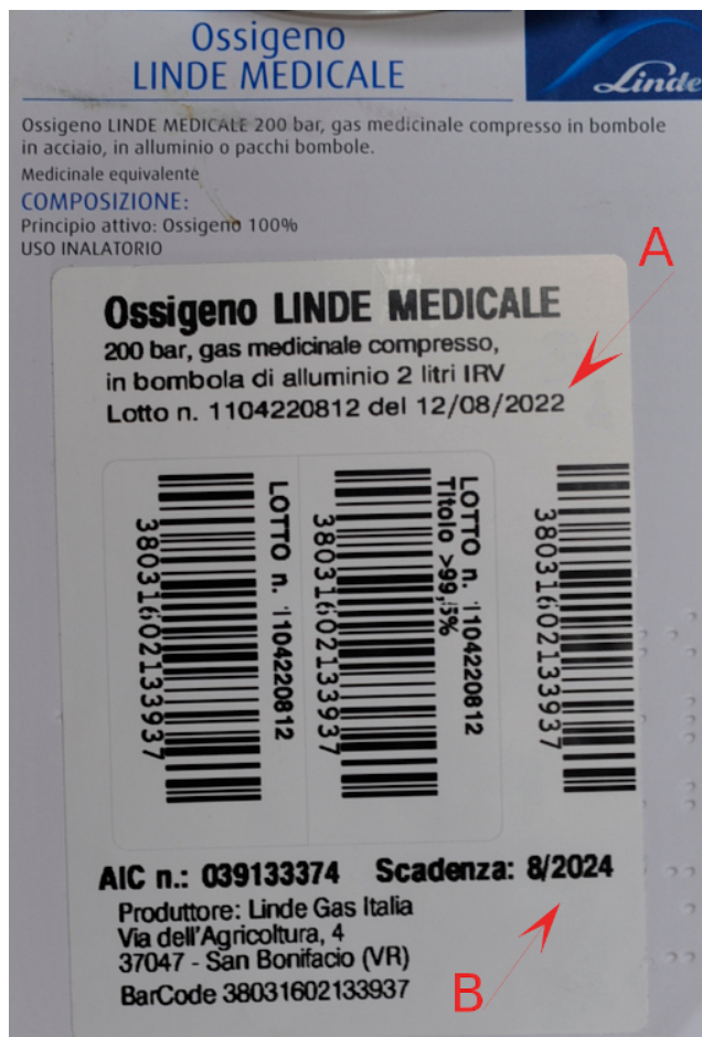
Figure 6. Data in cui la bombola è stata caricata e data di scadenza by Andrea Congiu
