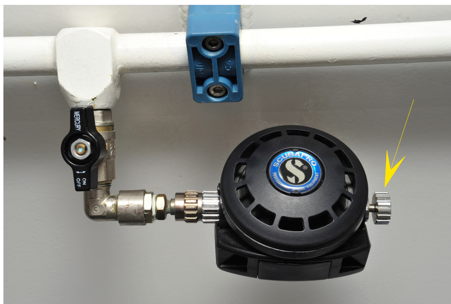
Figure 13. Regolatore di resistenza dell'erogatore - by Andrea Congiu
